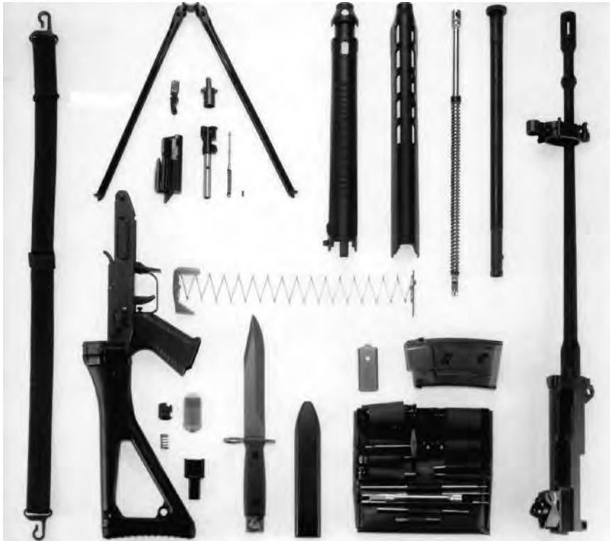
Figura 21: disposizione del fucile scomposto
