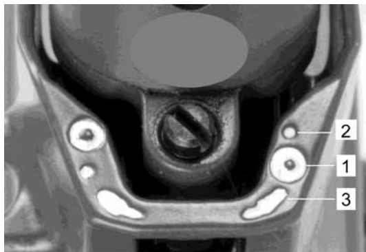
Figura 28: vite di correzione dell'elevazione
