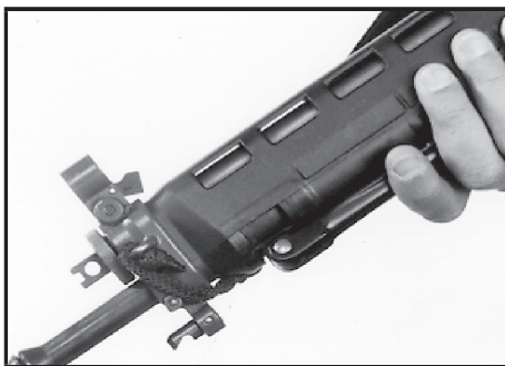
Figura 35: Modo di fissare la cordicella al portamirino, variante per mancini
