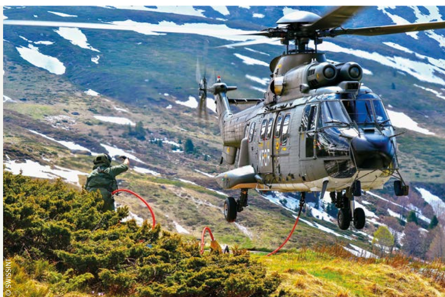
In Kosovo weist der Loadmaster den Helikopter ein, um die Transportleine für die darauffolgenden Unterlastarbeiten aufzunehmen.
