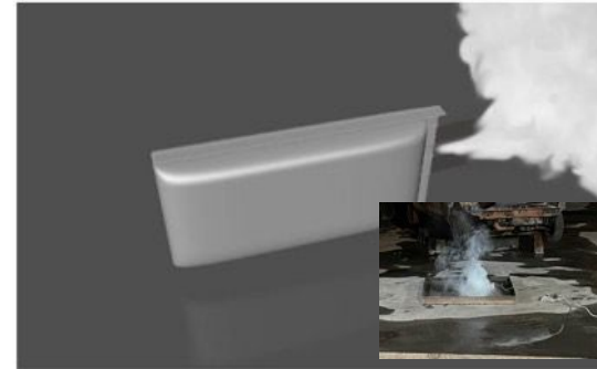
LiBa Zelle lässt Druck über Überdruckventil ab
