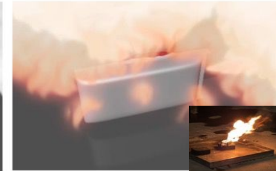
LiBa Zelle steht im Vollbrand und erhitzt weitere Batteriezellen
