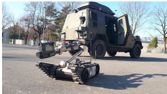
Figura 4 Robot d'esplorazione munito di un apparecchio di radiometria portatile
