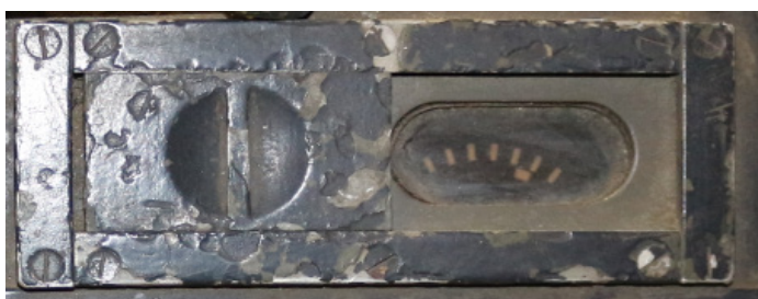
Illustration 33: Générateur manuel de l'appareil K1A avec marquage au radium 226
