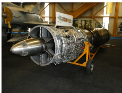
Illustration 27: Moteur du Mirage avec un alliage de magnésium et de thorium.
