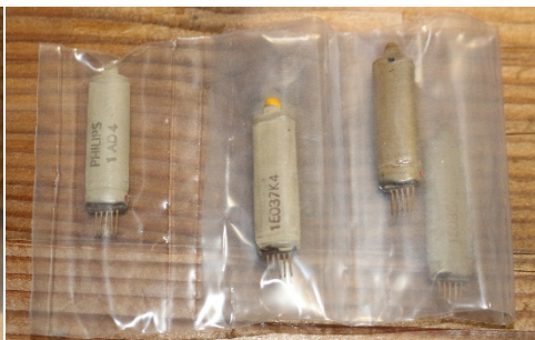
Illustration 16: Parafoudre dans le coffret de réparation du SE-208.
