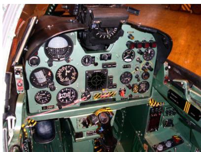
Illustration 25: Cockpit du Mirage avec divers instruments marqués avec du Ra-226.
