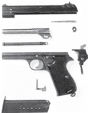
Bild 4: Zerlegung für die Reinigung
