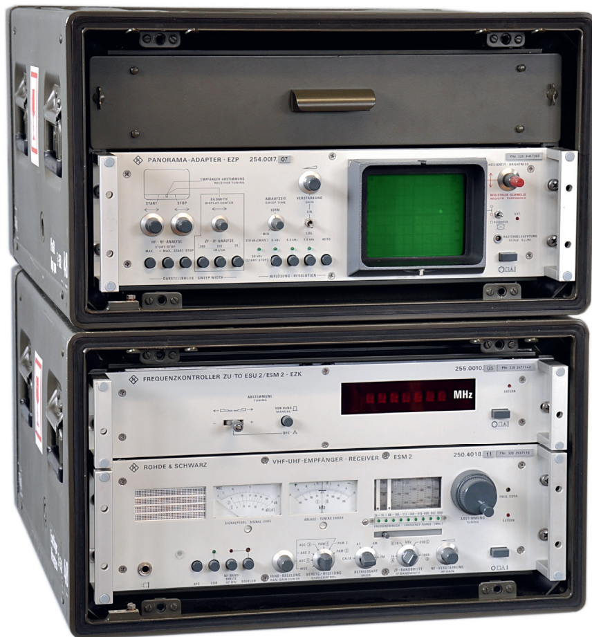
Empfangssystem VHF / UHF Rohde & Schwarz. Hergestellt von 1977 bis 1978. Stiftung HAMFU, Uster.
