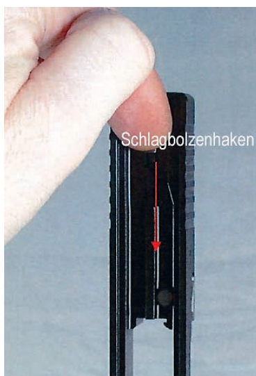
Abbildung 112 Druck auf den Schlagbolzenhaken in Laufrichtung
