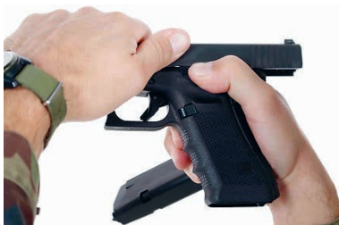
Abbildung 47 Verschlussstück zurückziehen und arretieren (Rechtshänder)
