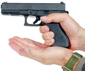
Abbildung 57 „TAP“ Schlag auf den Magazinboden, um das Magazin einzurasten
