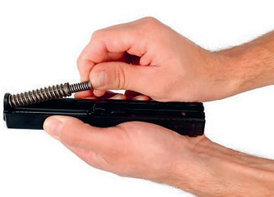
Abbildung 28 Ausbau der Schliessfeder
