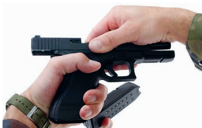
Abbildung 48 Verschlussstück zurückziehen und arretieren (Linkshänder)
