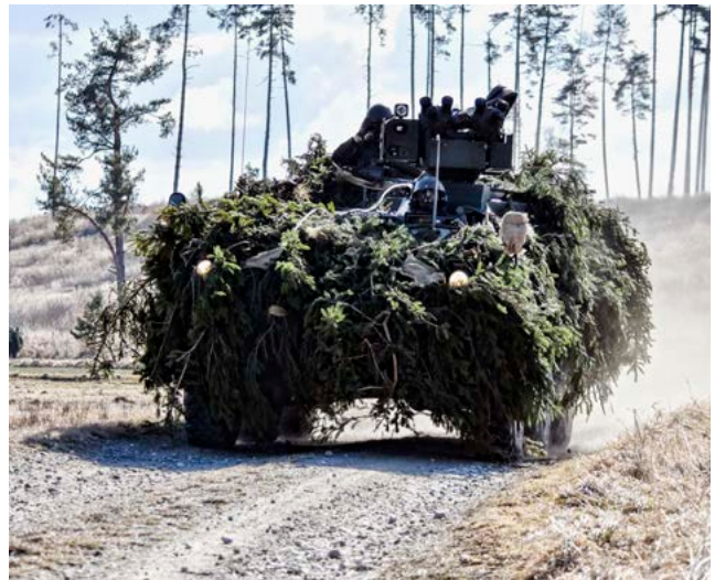
Abbildung 1: Der Schützenpanzer «Ulan» ist das Gefechtsfahrzeug der österreichischen Panzergrenadiere. Dank seiner starken Motorisierung ist er in der Lage, dem Kampfpanzer «Leopard» 2A4 in jedem Gelände zu folgen. (Quelle: © Österreichisches Bundesheer)
