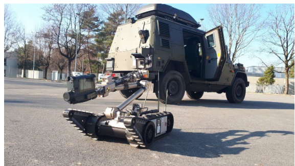
Abbildung 4 Mit einem tragbaren Radiometrie Gerät ausgerüsteter Roboter
