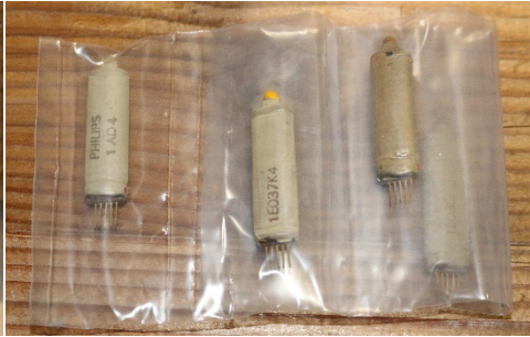
Abbildung 16: Überspannungsableiter in Reparaturkiste von SE-208.
