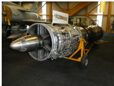
Abbildung 28: Mirage Triebwerk mit Magnesium-Thoriumlegierung.
