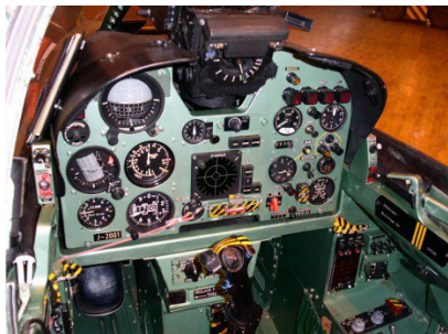
Abbildung 27: Mirage Cockpit mit diversen Ra-226 markierten Instrumenten.
