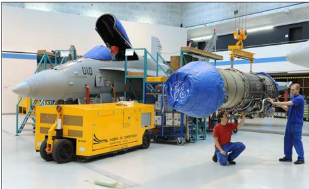
Abb. 2 Wechsel eines Triebwerks einer F/A-18 (RUAG)
