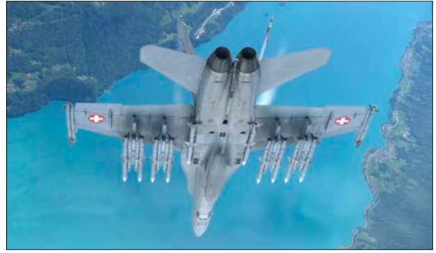
Abb. 8 F/A-18 in voller Bewaffnung mit 10 AIM 120 AMRAAM und 2 AIM 9X Sidewinder (LW)
