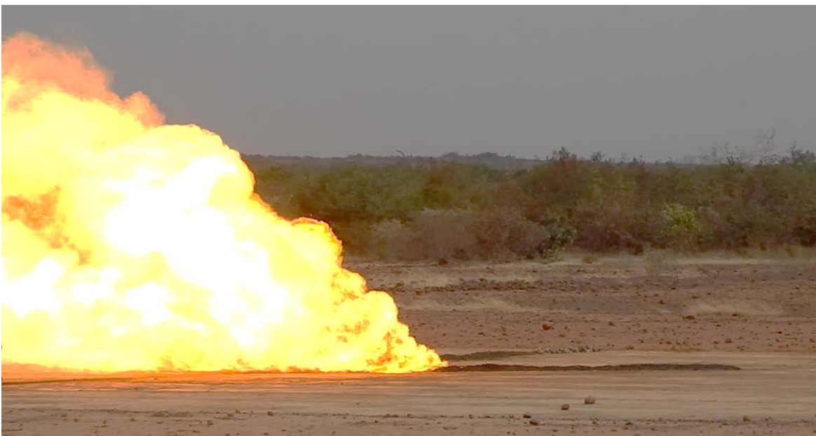
Offener Abbrand von Treibladungspulver, welches während der Demilitarisierung von patronierter Munition entfernt wurde.
