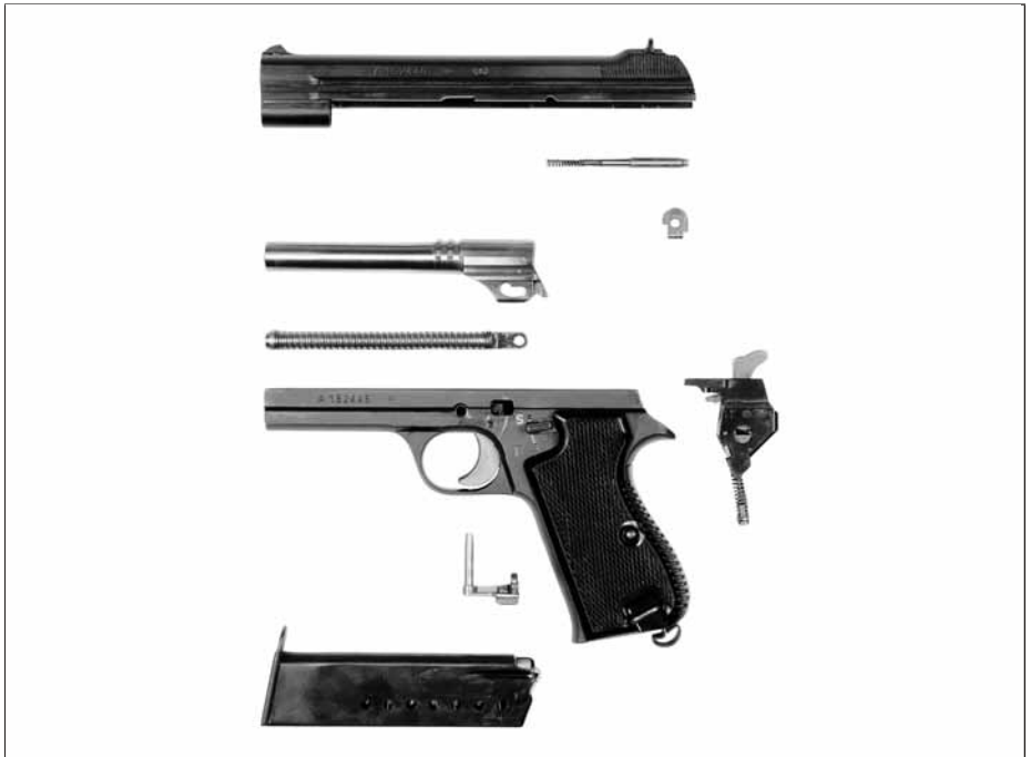
Abbildung 4: Zerlegung für die Reinigung
