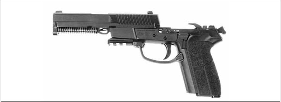
Abbildung 8: Verschlussstück auf das Griffstück von vorne aufschieben
