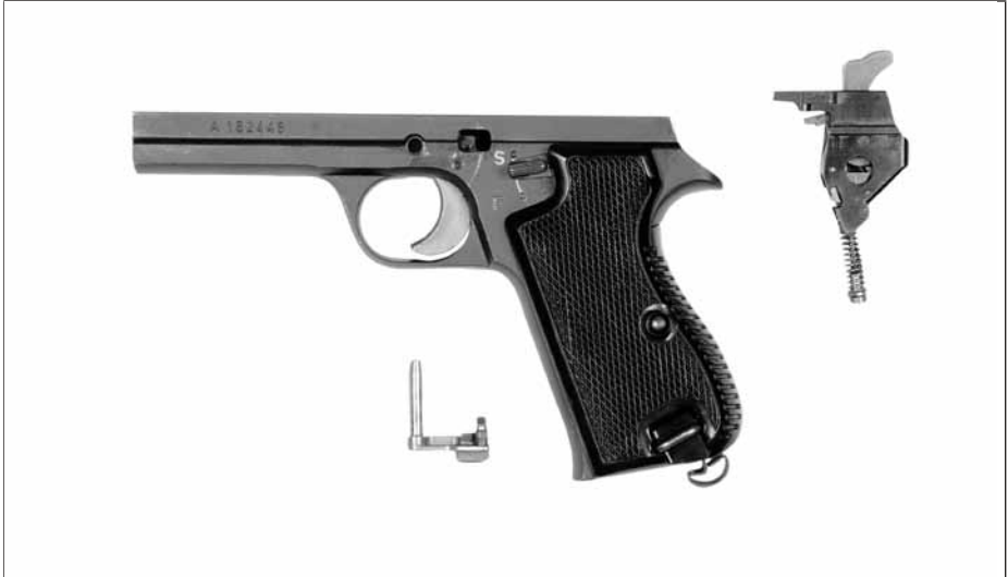
Abbildung 2: Beim Schuss feststehender Teil
