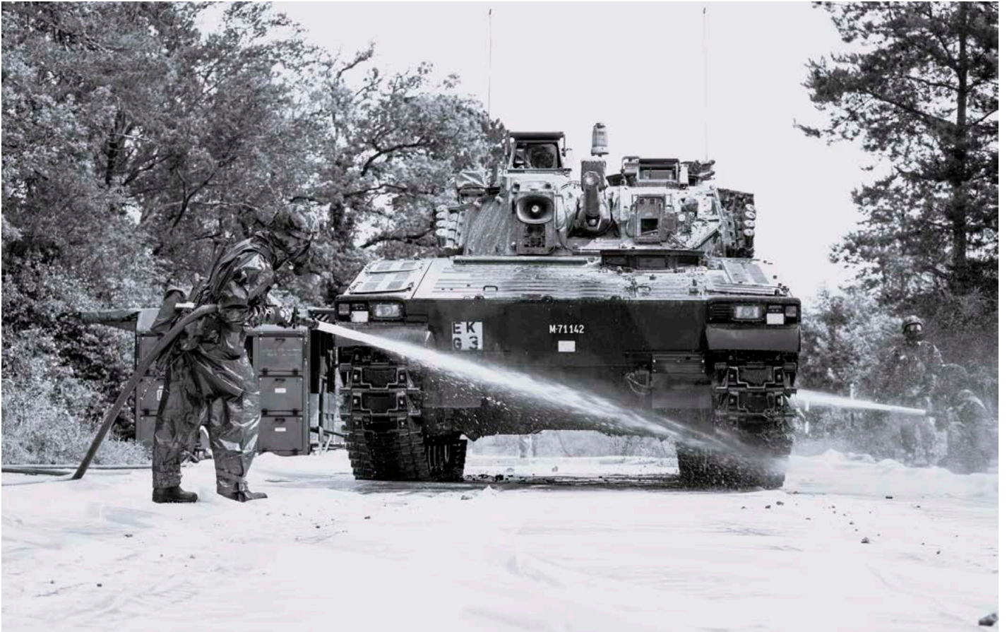
Schützenpanzer 2000 bei der gründlichen Dekontamination. (Quelle: ABC-KAMIR)
