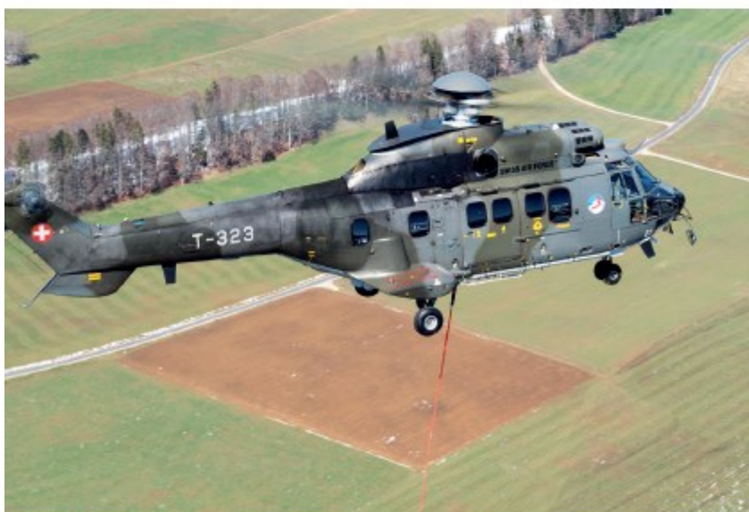
Der Helikopter vom Typ Airbus H215 "Super Puma" wurde für dieses Projekt verwendet - er benötigt zwei Piloten und drei Besatzungsmitglieder, die für die Bodenbeladung zuständig sind. L'hélicoptère de type Airbus H215 - Super Puma - a été utilisé pour ce projet - il nécessite deux pilotes et trois membres d'équipage responsables du chargement au sol.
