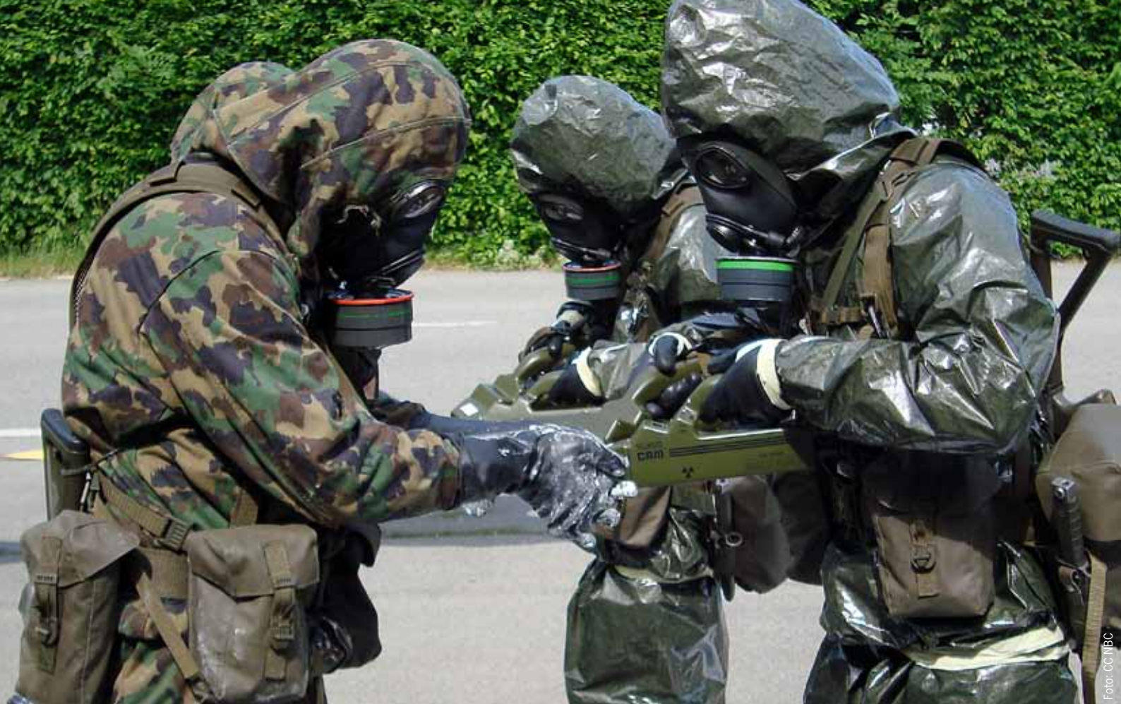
Misurazione di controllo effettuata con apparecchi di detezione C (ap det C 97) dopo una disintossicazione. Gli specialisti NBC (a destra) indossano la tuta di protezione C 2000.
