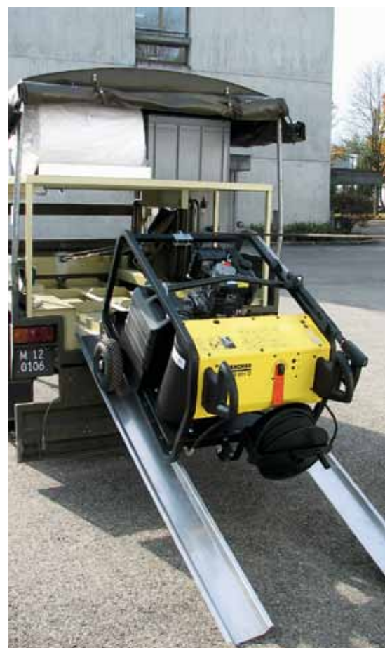
Il nuovo rimorchio della difesa NBC di tutte le truppe dotato di un pulitore ad alta pressione.
