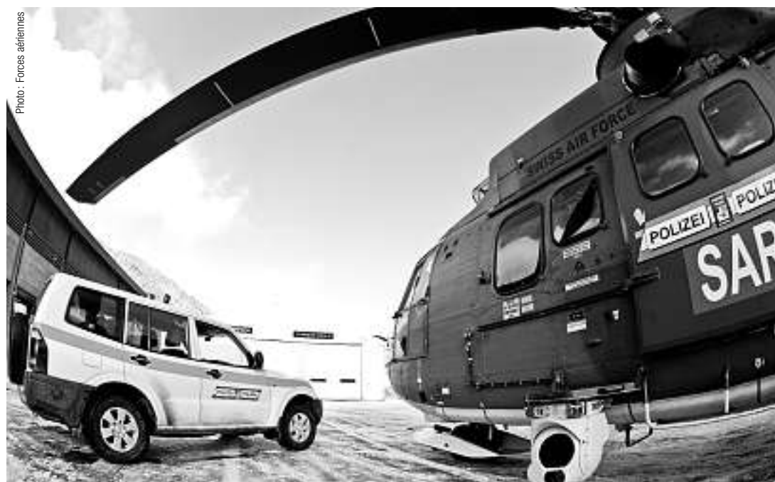
Les engagements du FLIR Super Puma sont également coordonnés depuis l'AOC. La photo montre l'hélicoptère équipé d'une caméra infrarouge lors d'un engagement au profit de la police cantonale des Grisons dans le cadre du World Economic Forum (WEF) à Davos.
