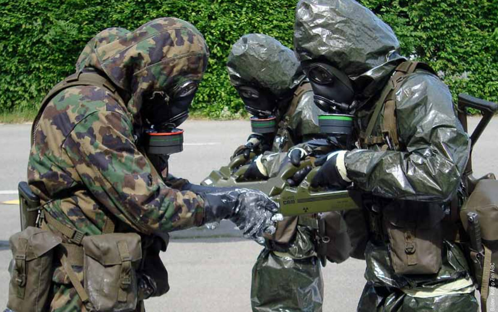
Kontrollmessung mit C-Nachweisgeräten (CNG 97) nach einer Entgiftung. Die ABC-Spezialisten (rechts) tragen den C-Schutzanzug 2000.
